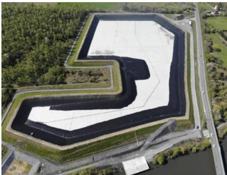
Le TD 13 (communes Condé-sur-l'Escaut et Vieux-Condé) d'une capacité de 340 000 m<sup>3</sup> est achevé et a reçu une autorisation de la DREAL le 23 septembre 2020 afin de pouvoir y déposer les sédiments extraits du canal. A ce jour environ 6500 m<sup>3</sup> de sédiments non pompables y ont été déposés en pelle-camion.
